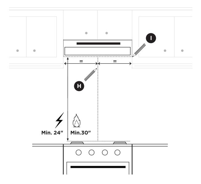
MIN. 24" OVER ELECTRIC/MIN. 30" OVER GAS
