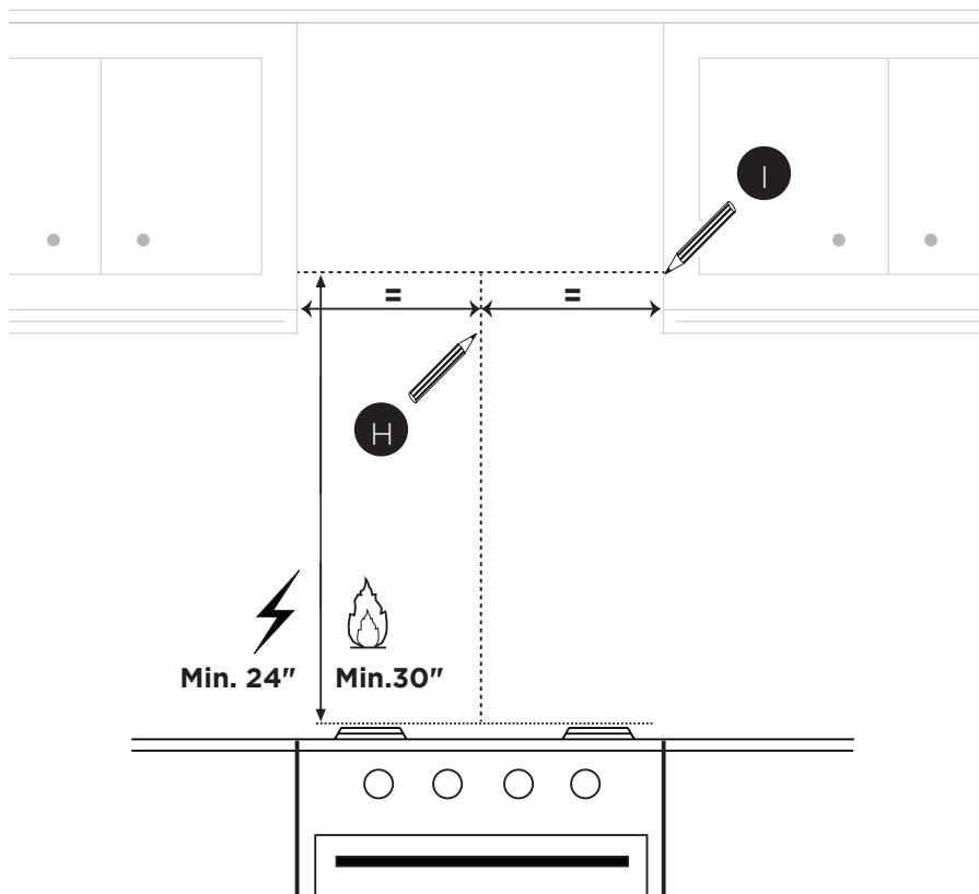
**MIN. 24" SUR ÉLECTRIQUE/MIN. 30" SUR GAZ**
